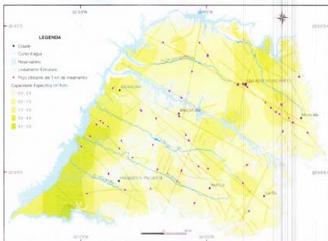
Figura 9 - Capacidade Específica de poços no Aquífero Bauru
