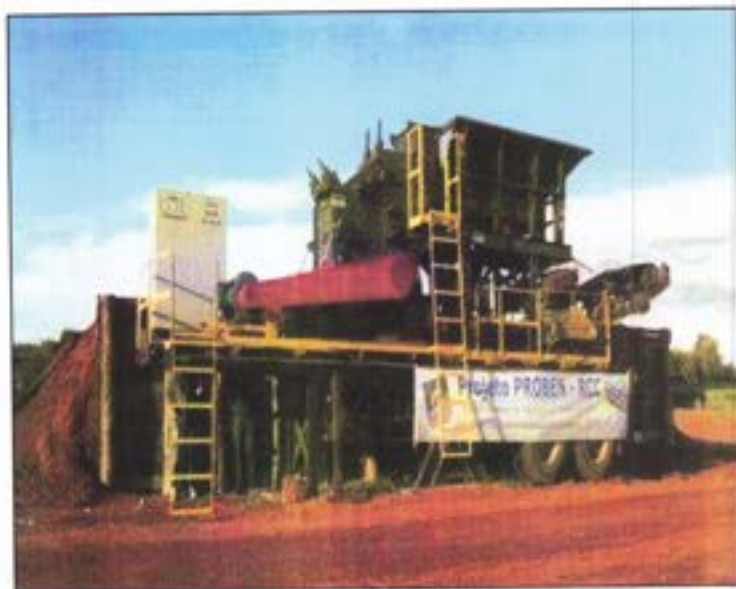
Figura 15 – Equipamento de beneficiamento de resíduos da construção civil
